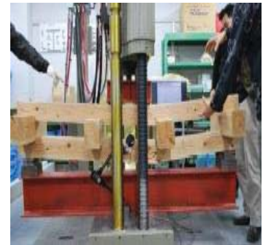
紀州材を用いた建築工法の破壊実験
